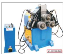
Максимальные параметры сечения. Для материалов с пределом прочности 42 кг/мм<sup>2</sup> (60000 фунтов на кв. дюйм) и пределом текучести 25 кг/мм<sup>2</sup> (36000 фунтов на кв. дюйм) гибка осуществляется в несколько проходов.
